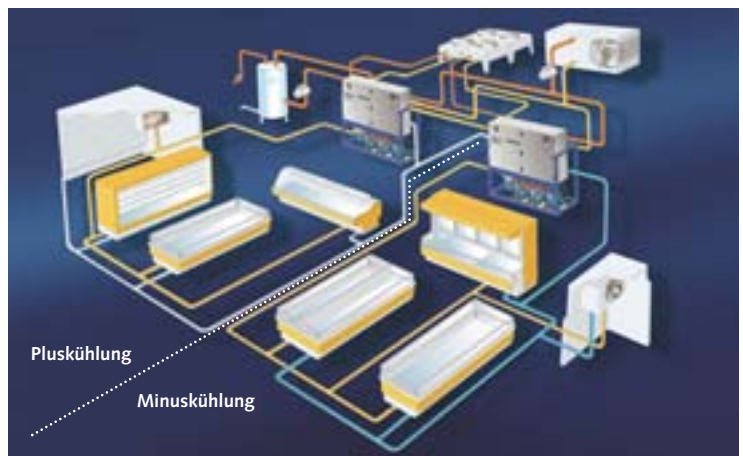
Verbundkälteanlagen für Plus- und Minuskühlung (Linde Kältetechnik GmbH & Co.KG)
