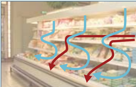
Durchzug bläst den Kälteschleier aus dem Gerät
